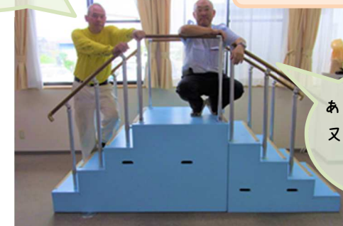
4. アルミパイプと32mmの木製手すりは自在金具で固定します。中央の手すりは階段の向きに合わせて変更出来るよう回転止めねじが付き金具を使用しています。
